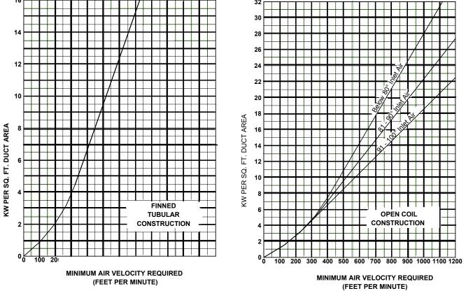
FIG. 1 - MINIMUM AIR VELOCITY REQUIRED FOR SAFE OPERATION
