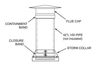
GAS FURNACE FUEL VENTING PARTS
