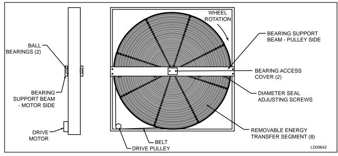
FIG. 3-11 - ENERGY RECOVERY WHEEL - PULLEY SIDE
