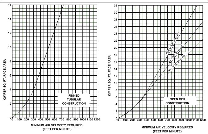
FIG. 3-25 - MINIMUM AIR VELOCITY REQUIRED FOR SAFE OPERATION
