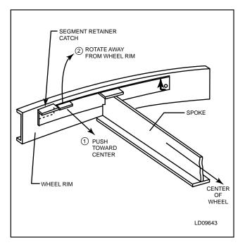
FIG. 3-12 - SEGMENT RETAINER
